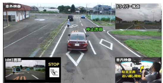
ドライバーとの協調によりリスクを未然回避するCI運転支援
